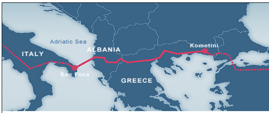
FIGURA 16 – IL GASDOTTO TRANS-ADRIATIC PIPELINE
